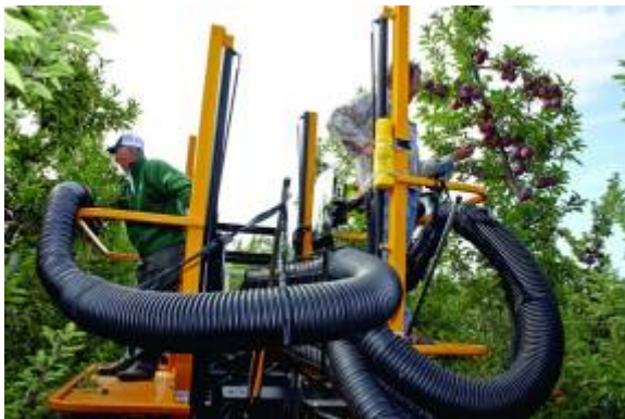
Слика бр. 76 – Платформа која омогућава да берачи сами себе померају по висини
