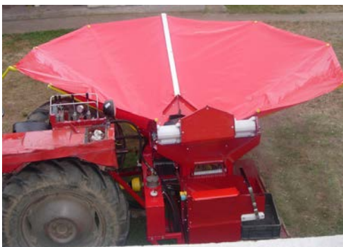
Слика бр. 82 – Тресач воћа са уређајима за: трешење, прикупљање плодова, транспорт плода и одстрањивање лишћа и гранчица
