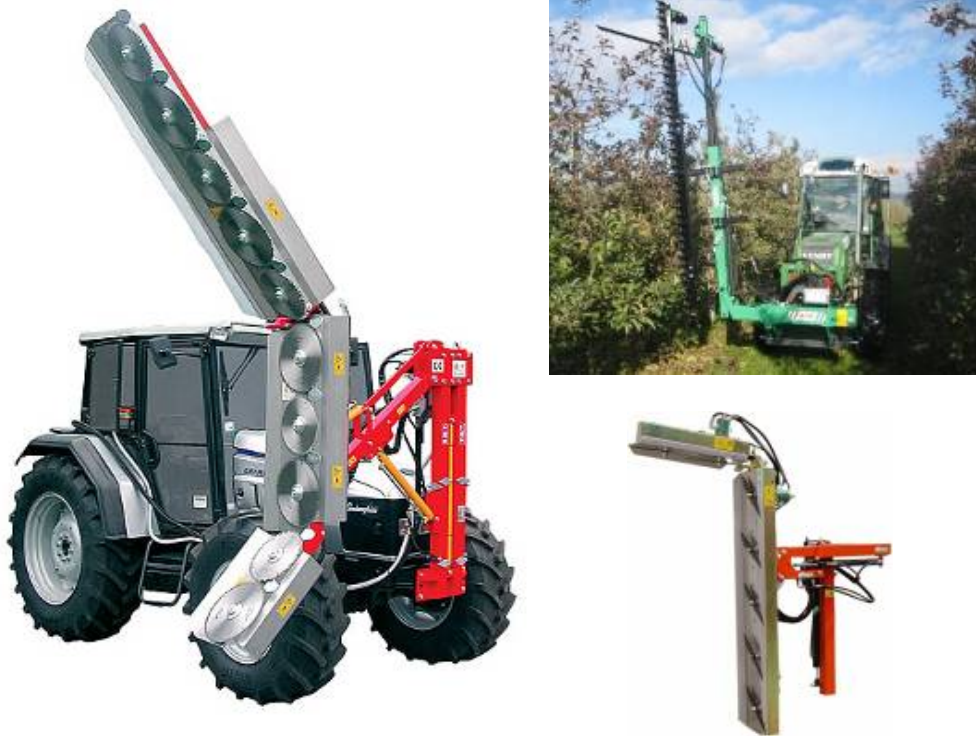
Слика бр. 70 – Машине за резидбу са различитим радним елементима
