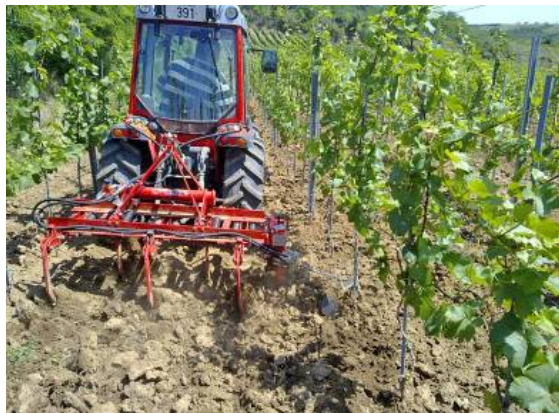
Слика бр. 21 – Међуредна обрада без превртања земљишта
