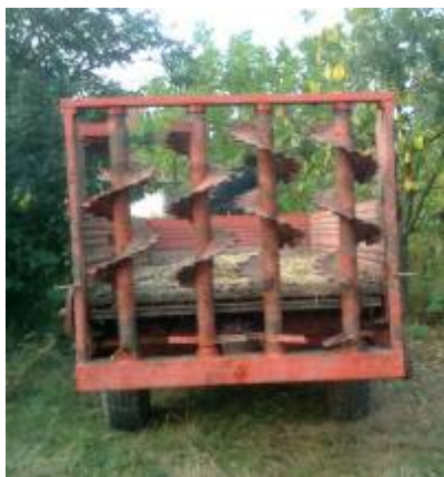
Слика бр. 41 – Вертикални и хоризонтални ротори за растурање стајњака
