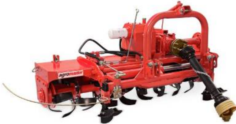
Слика бр. 31 – Ротофреза за међуредну и редну обраду
