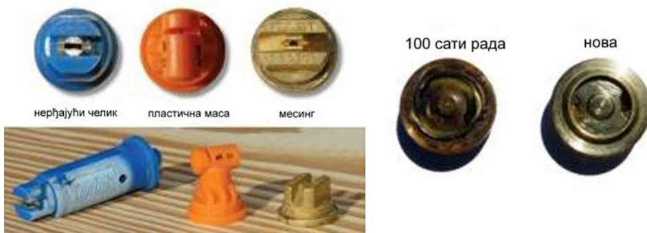
Слика бр. 51 – Дизне израђене од разних материјала и хабање месинганих дизни
