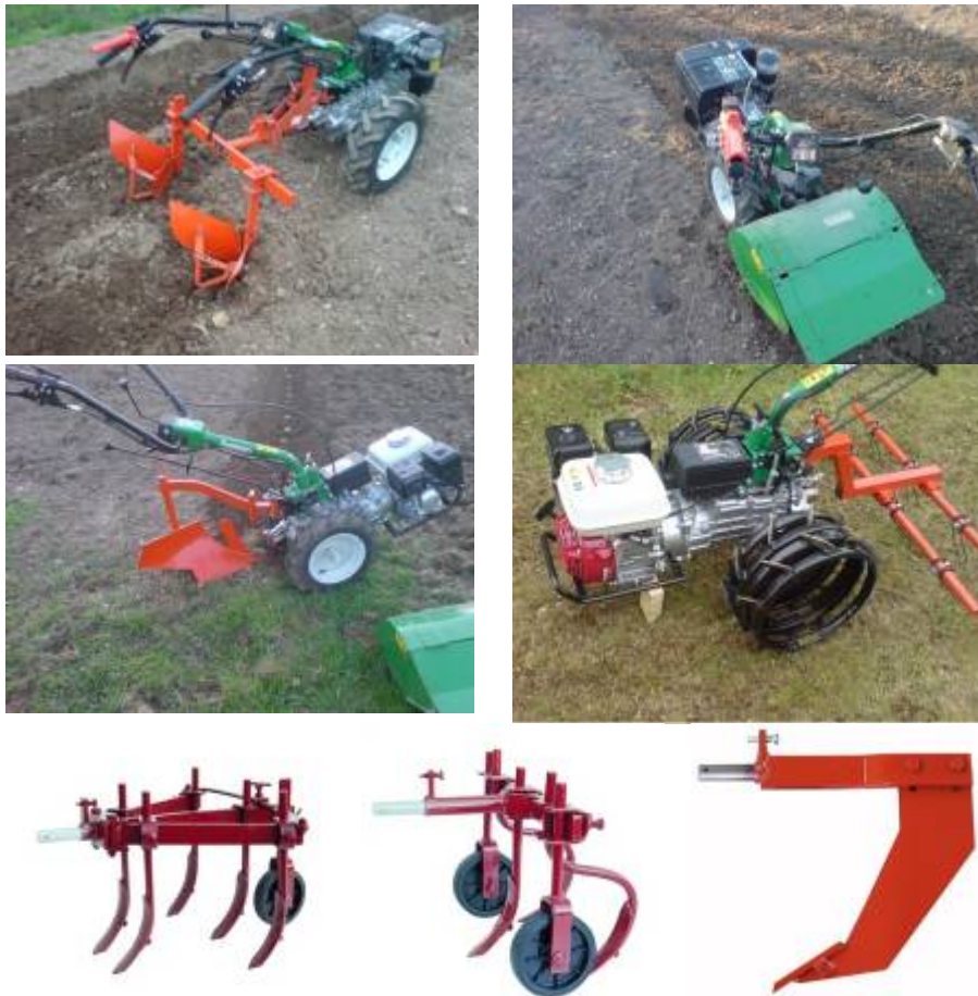
Слика бр. 3 – Неке од прикључних машина за једноосовински трактор
