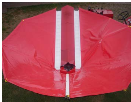
Слика бр. 82 – Тресач воћа са уређајима за: трешење, прикупљање плодова, транспорт плода и одстрањивање лишћа и гранчица
