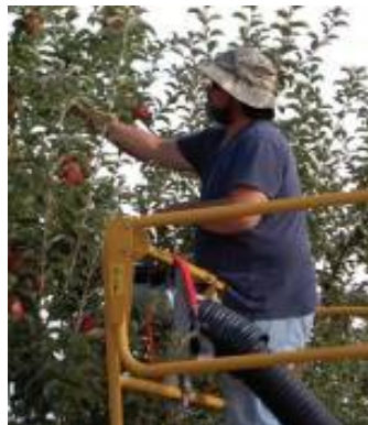
Слика бр. 76 – Платформа која омогућава да берачи сами себе померају по висини
