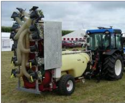
Слика бр. 67 – Атомизер са сензорима
