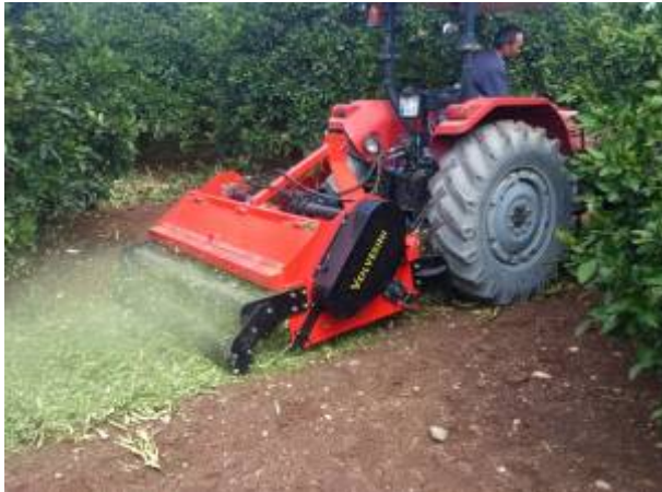
Слика бр. 48 – Уситњавање и растурање траве
