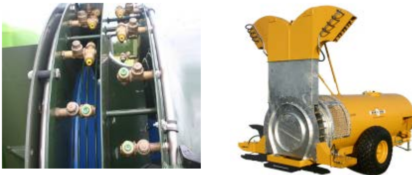
Слика бр. 62 – Носач дизни и атомизер са усмеривачем ваздуха
