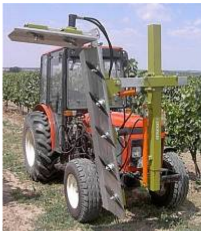
Слика бр. 72 – Машина за резидбу ножевима
