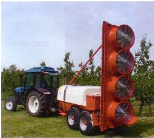
Слика бр. 65 – Атомизер који даје хоризонталну струју млаза
