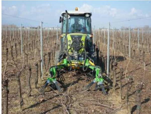
Слика бр. 73 – Машина за прикупљање остатака резидбе
