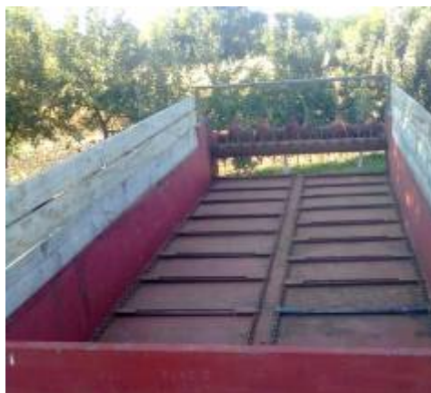
Слика бр. 41 – Вертикални и хоризонтални ротори за растурање стајњака
