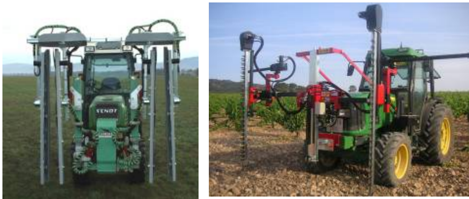
Слика бр. 69 – Машине за резидбу два реда и два полуреда
