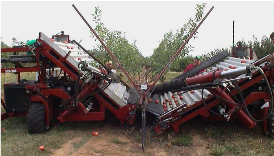
Слика бр. 84 – Тресач са прихватним платформама
