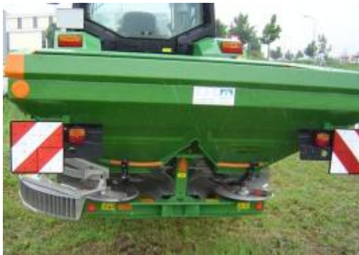
Слика бр. 44 – Центрифугални расипач са два ротирајућа диска
