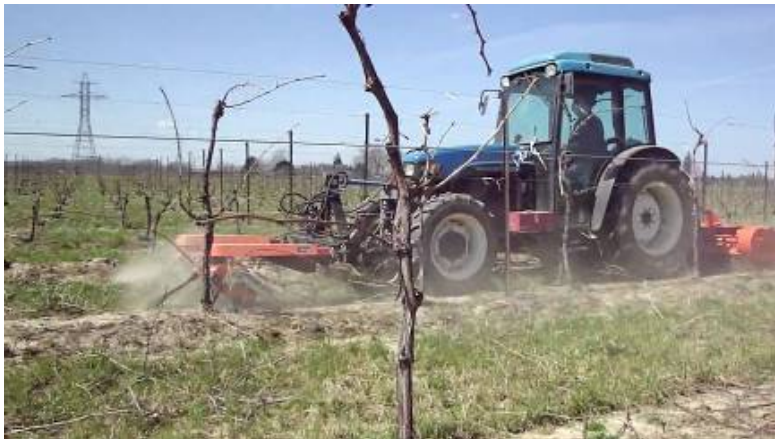
Слика бр. 74 – Машина за сакупљање и ситњење остатака резидбе
