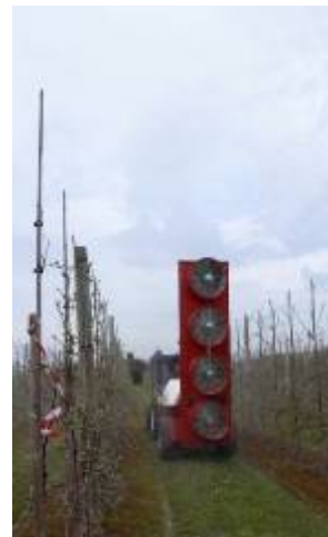
Слика бр. 65 – Атомизер који даје хоризонталну струју млаза
