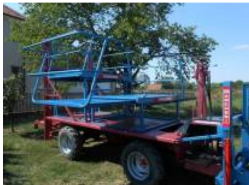
Слика бр. 75 – Покретне платформе једноставне конструкције
