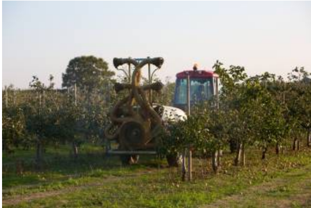
Слика бр. 64 – Атомизер са усмеравајућим цревима
