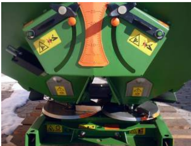
Слика бр. 46 – Подешавање протока на расипачу
