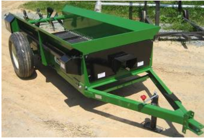
Слика бр. 42 – Приколица са погоном од вратила трактора.
